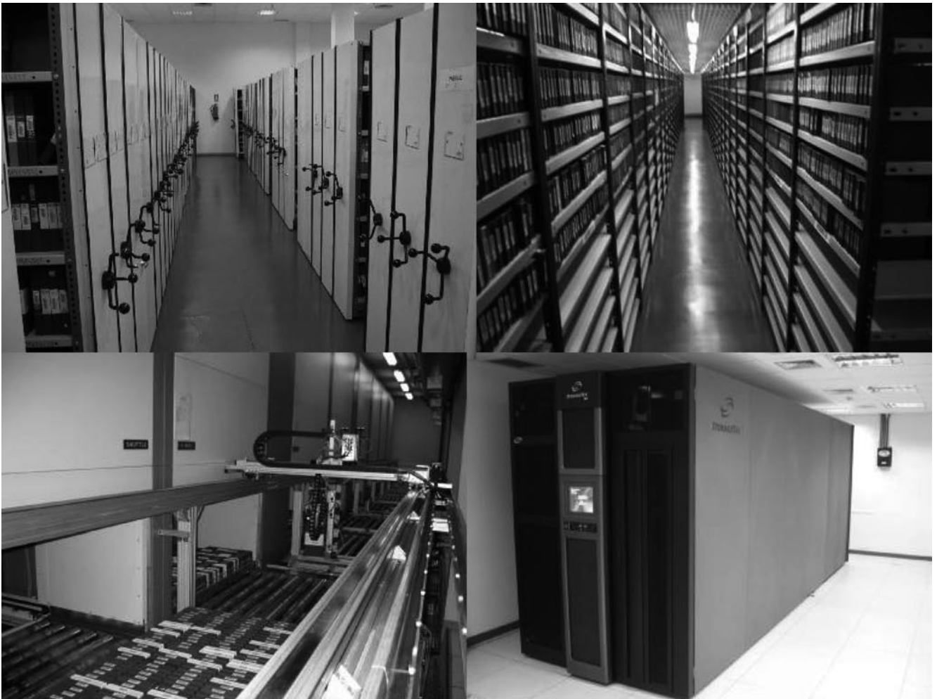
Fig. 4. Diferentes sistemas de archivo convencional de cintas y librería digital Storagetek SL-8500, con capacidad para varios cientos de miles de horas de vídeo en formato profesional
